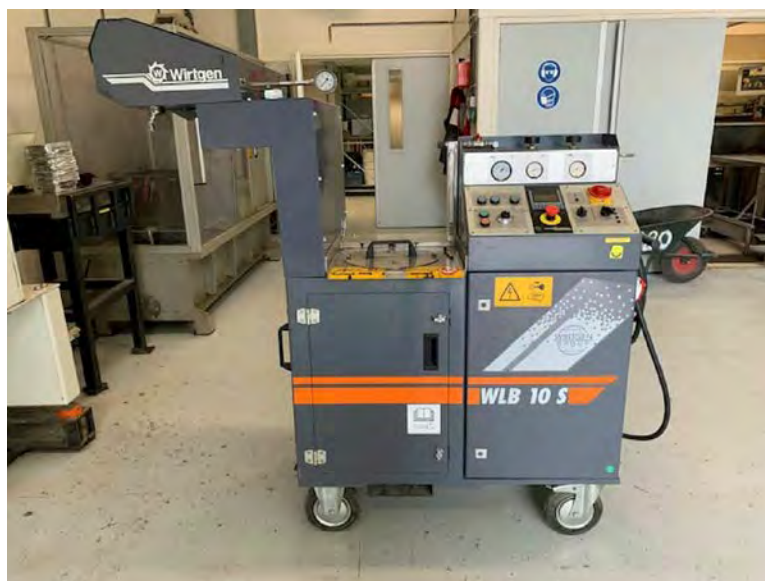
Figuur 4. Wirtgen WLB 10S laboratorium schuimunit
