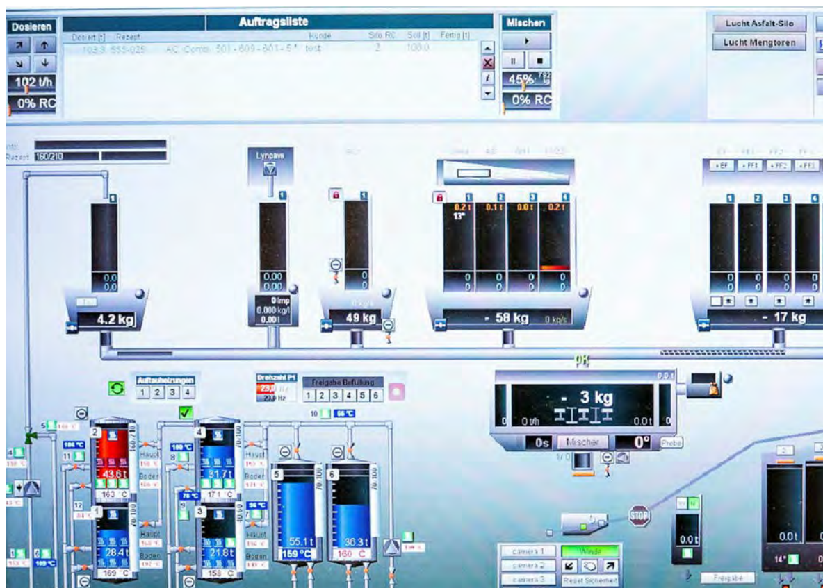
Figuur 5. Illustratie van besturingssysteem bij asfaltmenginstallatie
